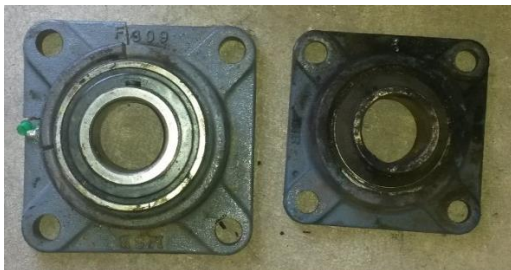
Photos 1 et 2 : Palier neuf en pied de vis de transfert et paliers remplacés sur la vis de transfert
